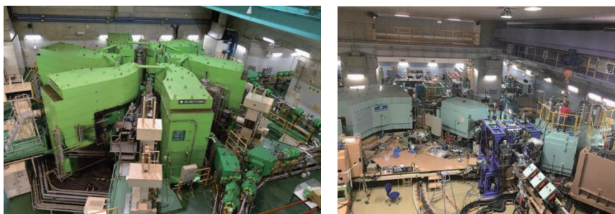
図 2.2：左写真：大阪大学核物理研究センターのリングサイクロトロン加速器。右写真：高分解能スペクトロメータ「グランドライデン」（左）、クローバーガンマ検出器アレイ CAGRA (中央)、大スペクトロメータ LAS (右)。
